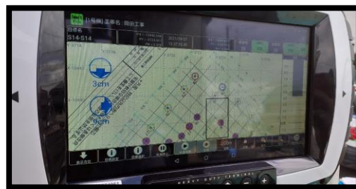
タブレットによる誘導画面(写真②)
